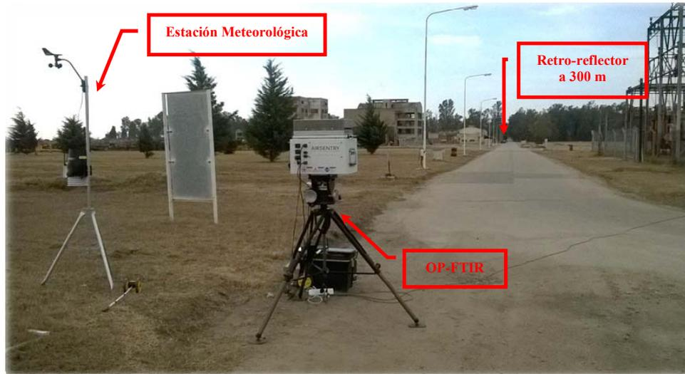
Foto N° 3: OP-FTIR Monostático (con retro-reflector), marca Cerex, modelo AirSentry
