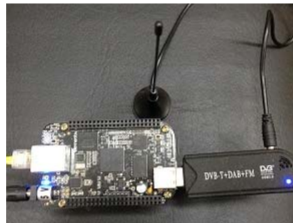
Fig. 3 Interconexión de los elementos que forman el monitor remoto.
