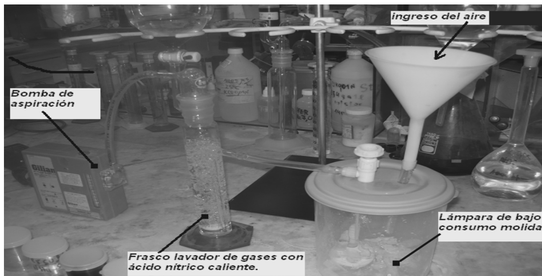
Figura 1. Dispositivo para capturar vapores de mercurio en lámparas de bajo consumo por rotura causada con percusión.
