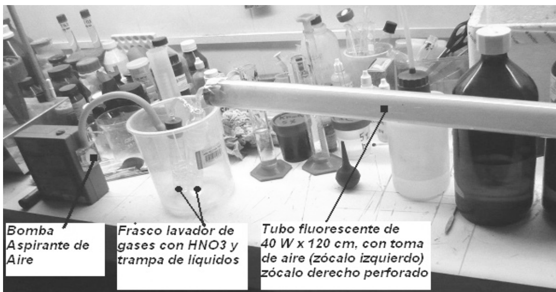
Figura 3. Tren de muestreo para capturar vapores de mercurio en tubos fluorescentes
