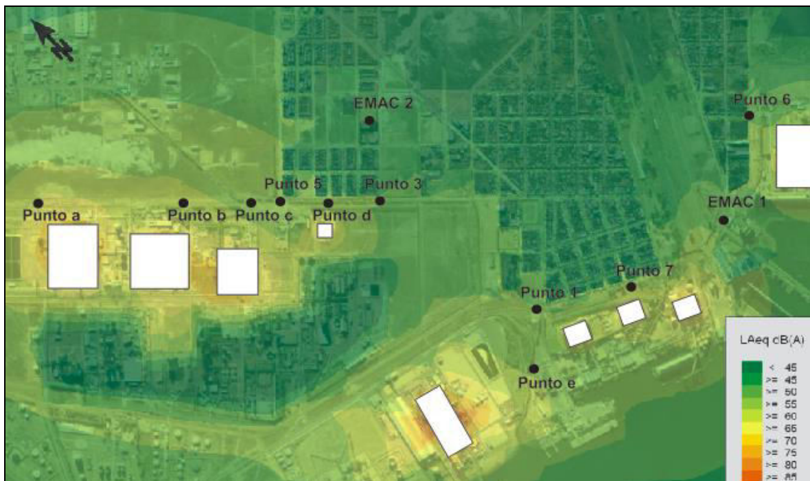
Figura 6. Mapa acústico originado por el ruido industrial en la zona de estudio.
