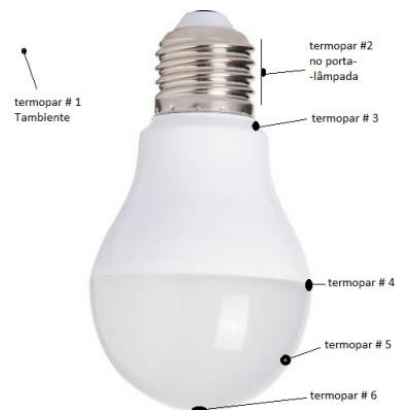
Fig. 3 - Lâmpada tipo LED-A (pera) com base E-27, 12 W, e indicação de regiões amostradas.
