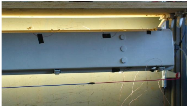
Fig. 1 - Luminária com lâmpadas tubulares montada voltada a parede vertical posterior.
