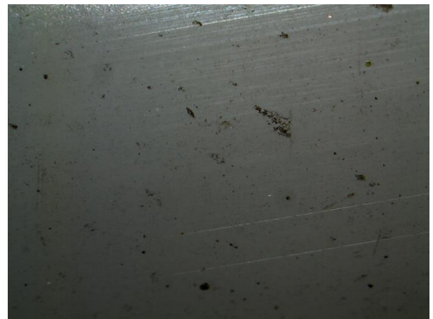
Fig. 8. Fotografía de la superficie del recubrimiento del tubo, con 22x, antes de ser realizada la limpieza con alcohol.
