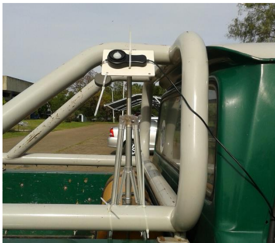
Fig. 3. Foto que muestra el montaje del sensor. Durante la medición, se conecta el instrumento a un PC el que mediante un cable tipo USB permite almacenar los datos en tiempo real y controlarlos mediante una gráfica en la pantalla del ordenador.
