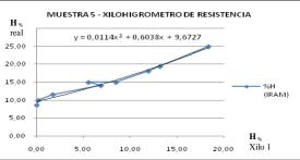
Con la aplicación del software se obtuvo la función que mejor ajusta el tenor de humedad obtenido en los xilohigrómetros con la humedad real de la probeta. Las funciones tienen una aproximación razonable dentro del rango del 8% al 22% de humedad Las ecuaciones de corrección propuestas se presentan en la tabla 3:
