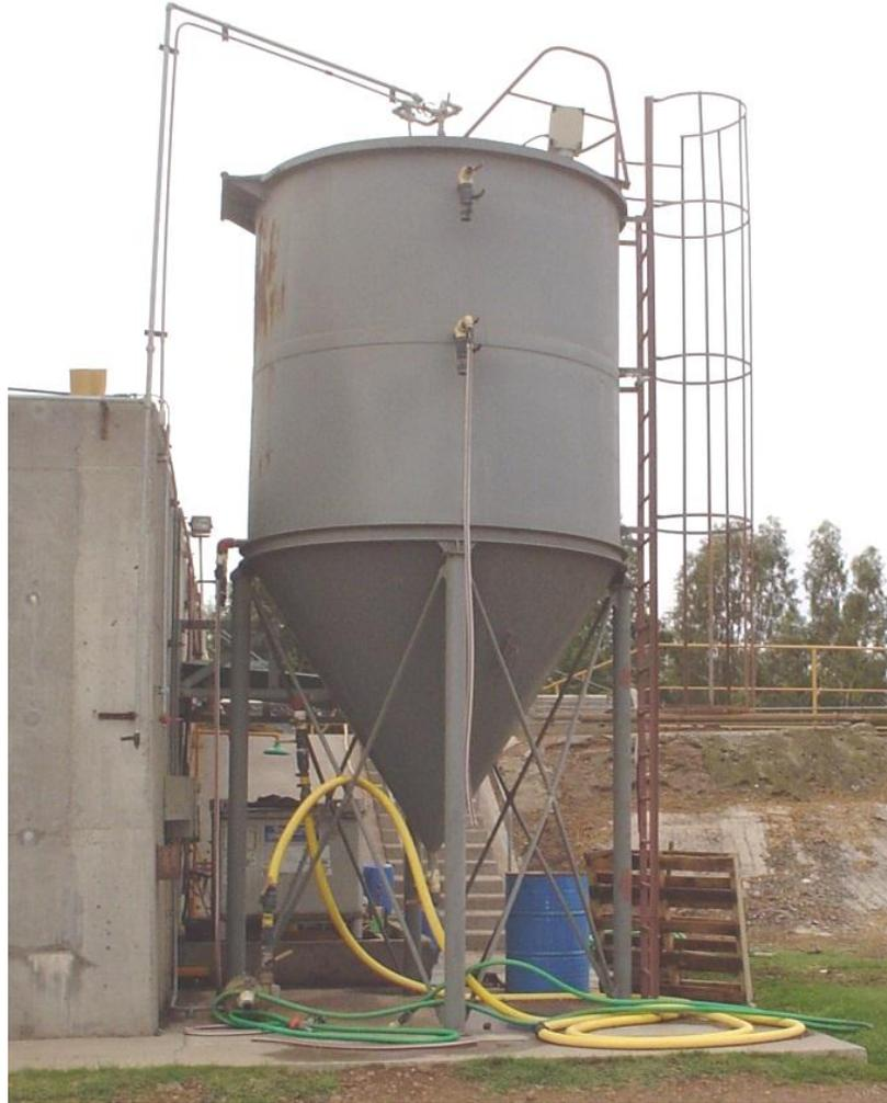
Figura 10. Digestor a escala piloto
