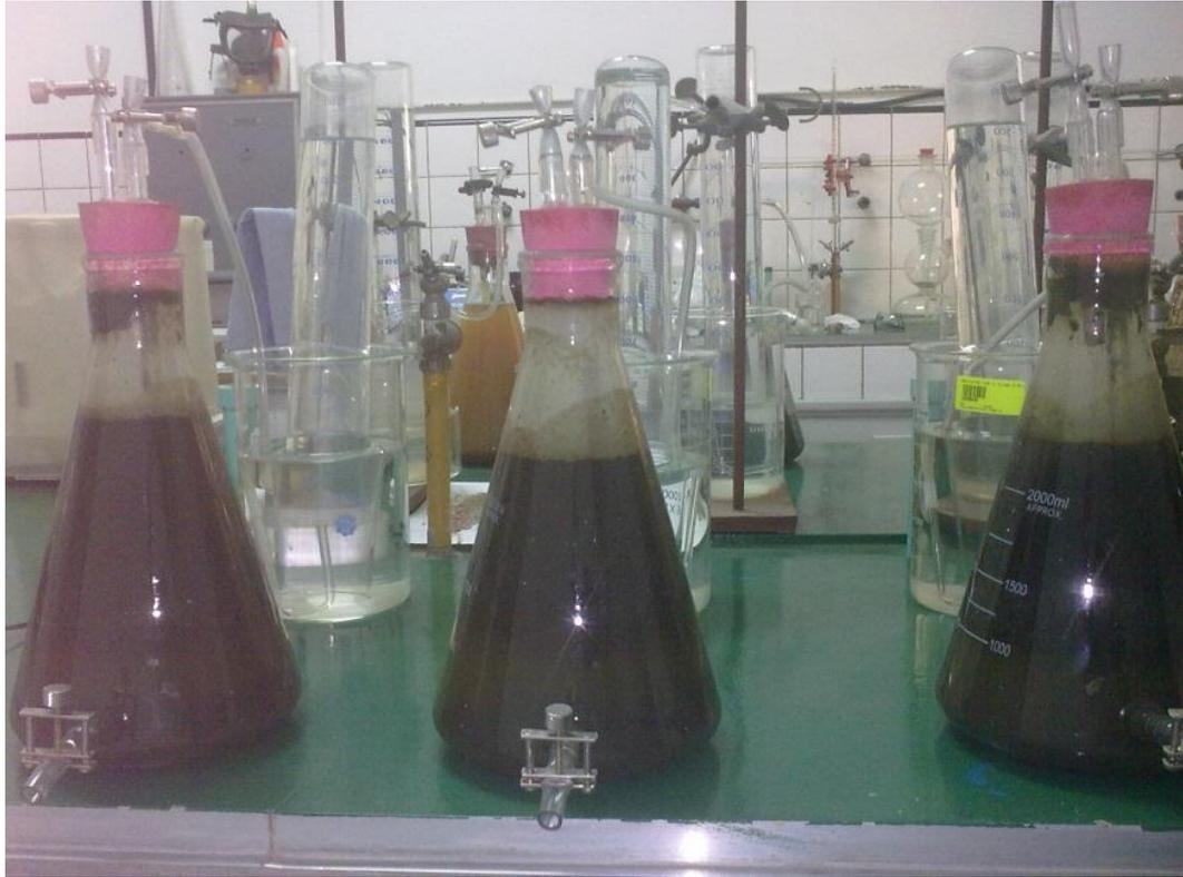
Figura 7. Reactores anaeróbicos a escala laboratorio
