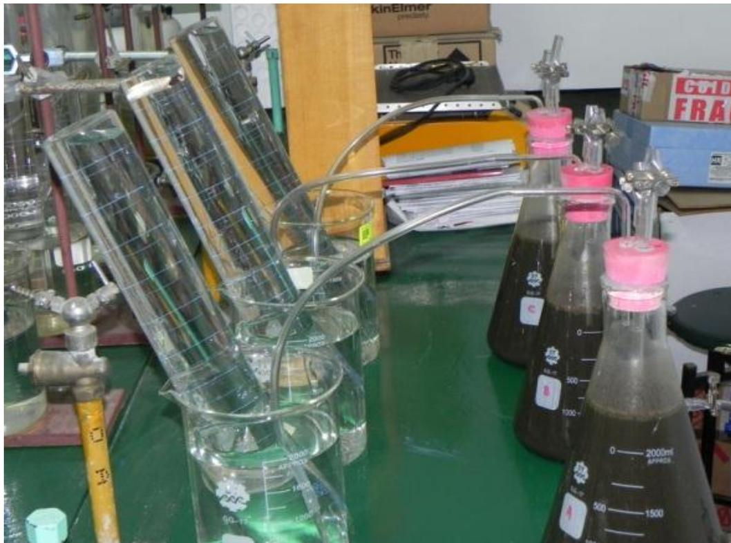
Figura 8. Reactores, sellos de agua y probetas para medir biogás
