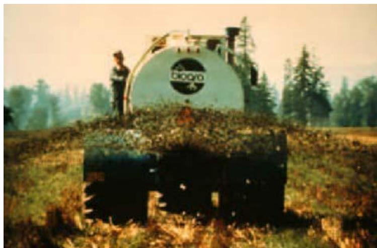
**FIGURA 5 – Aplicación de biosólidos en superficie**
