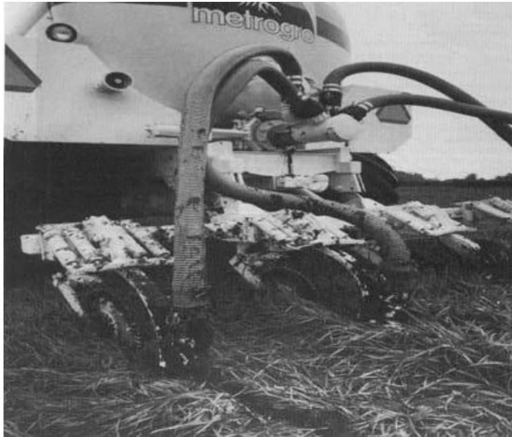
**FIGURA 4 – Equipo de inyección de biosólidos**
