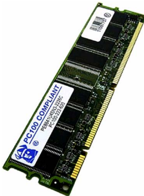
Fig. 52. Presentación de una DIMM de 168 contactos en tecnología SRAM con bus de 100 MHz (PC100).
