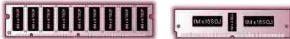
Fig. 45. Comparación entre una DIMM de 168 contactos y una SIMM de 72.
