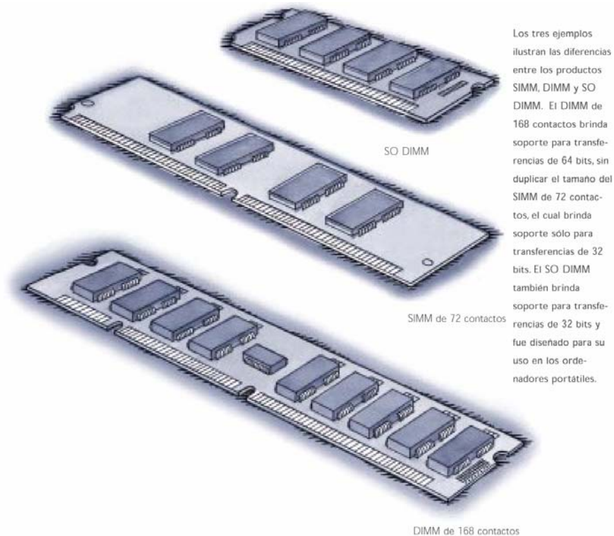
Fig. 48. Tres módulos actuales. SO DIMM de 72 contactos, SIMM de 72 contactos y DIMM de 168 contactos.
