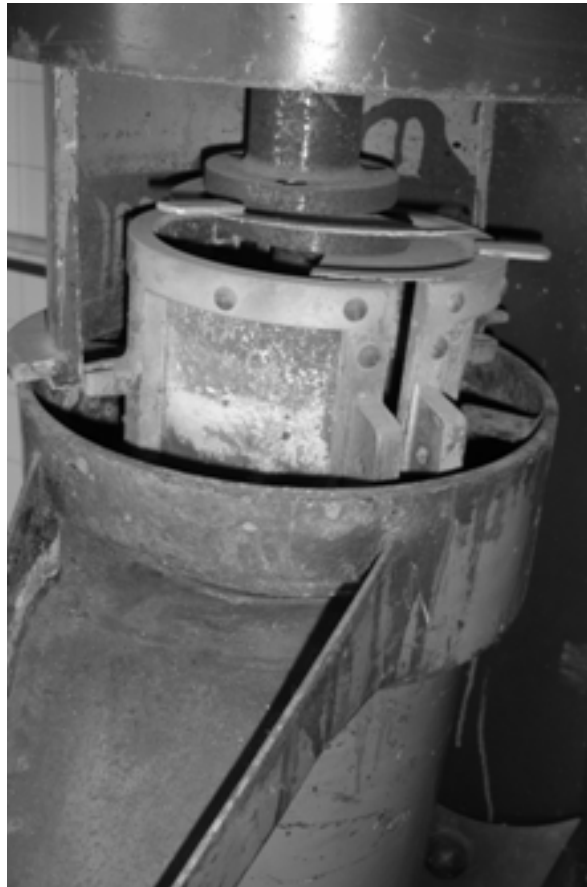
Figura X.4. Malla de retención de las bolillas molturantes y boca de descarga en un molino de perlas
