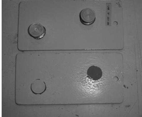
**Figura XIII.26. Panel pintado con dispositivos para ensayo de adhesión por tracción**
