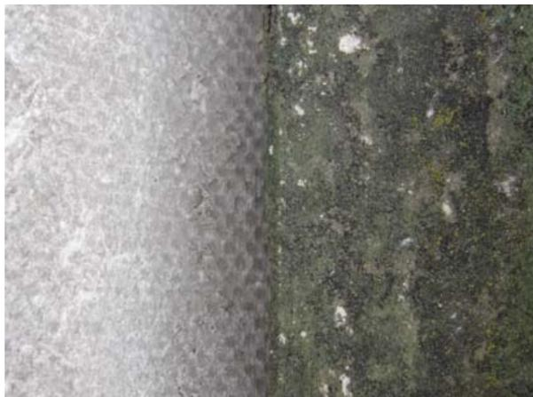
**Figura XII.11. Falla de película por la acción de hongos sobre chapa de fibrocemento, formulada con y sin fungicidas eficientes (izquierda y derecha, respectivamente)**
