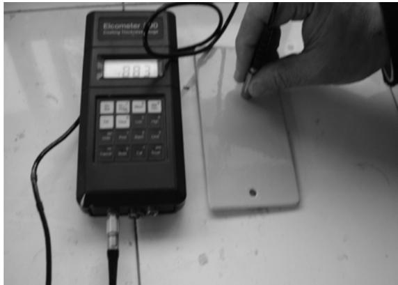
**Figura XIII.7. Medidor de espesor de película seca.
