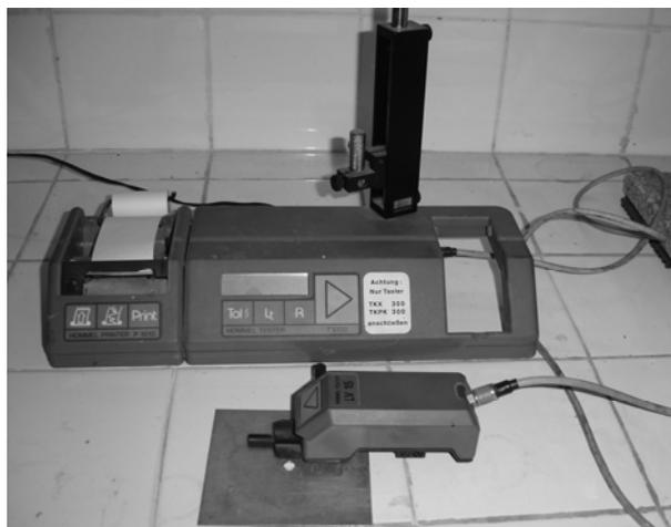
**Figura XIII.2. Medidor de rugosidad**
