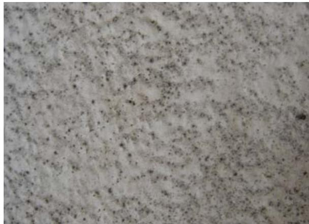
**Figura XII.19. Corrosión generalizada de un sustrato metálico**
