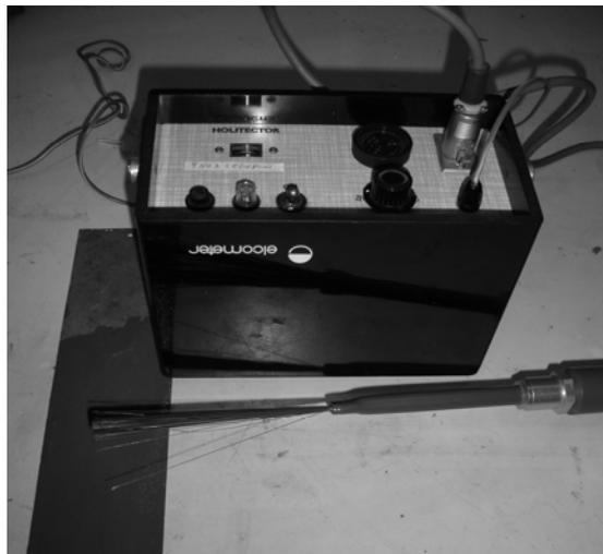
**Figura XIII.9. Detector de poros en películas sobre sustratos metálicos por descarga eléctrica**
