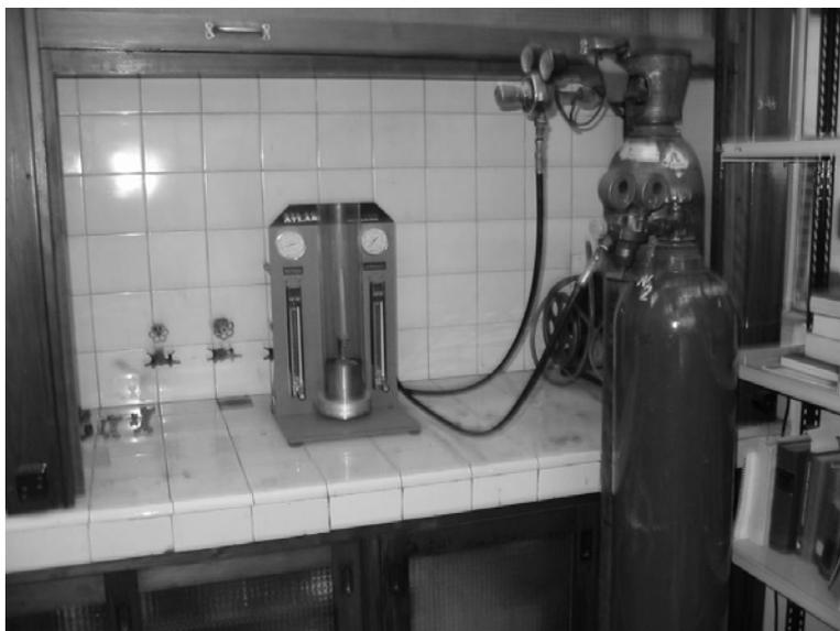
**Figura XIII.29. Equipo para determinar el Índice de Oxígeno Límite**
