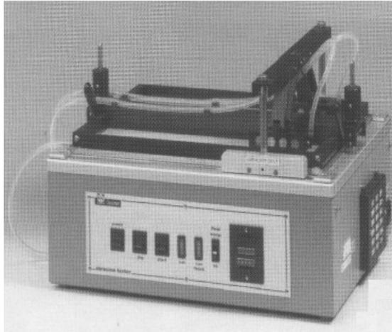
**Figura XIII.21. Resistencia a la abrasión; desgaste por fricción**
