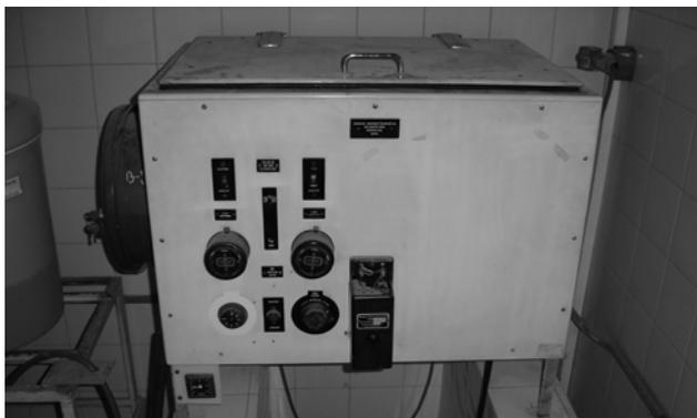
**Figura XIII.17. Cámara de Humedad y Temperatura Controladas**
