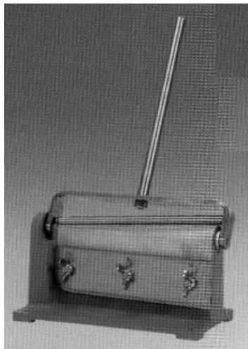
**Figura XIII. 24. Dispositivo para determinar la flexibilidad de películas**
