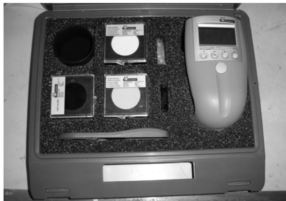
**Figura XIII.12. Medidor de color portátil**
