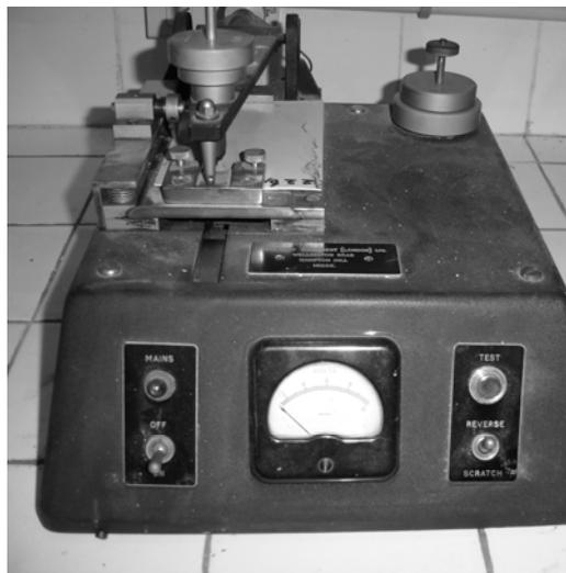
**Figura XIII.22. Medidor de resistencia al rayado ("Scracht test")**
