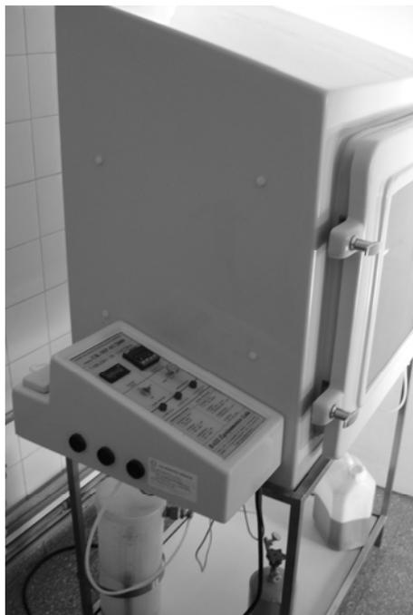
**Figura XIII.16. Cámara de ensayo de corrosión con atmósfera de dióxido de azufre**
