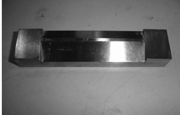
**Figura XIII.3. Extendedor para obtener películas de pintura de espesor uniforme**
