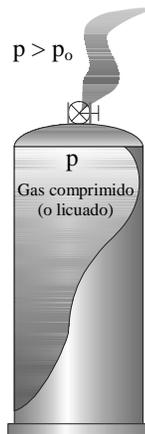
Fig. 1-3 Sistema abierto a régimen no-permanente (vaciado de un recipiente)
