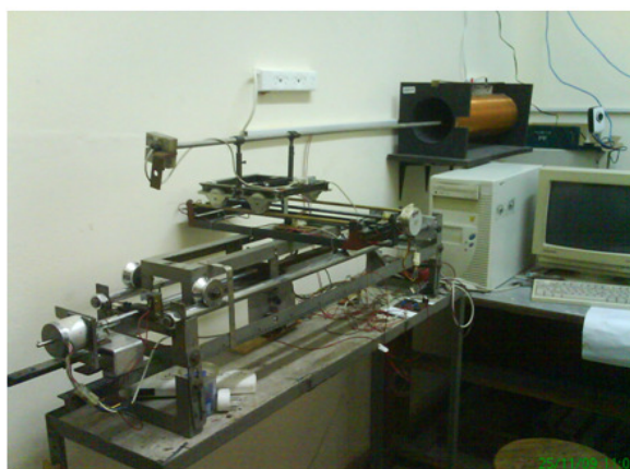
Figura 2: Solenoide para mapeo de campos magnéticos
