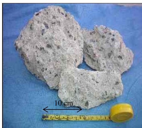
Figura 6. Rotura de hormigón de demolición
