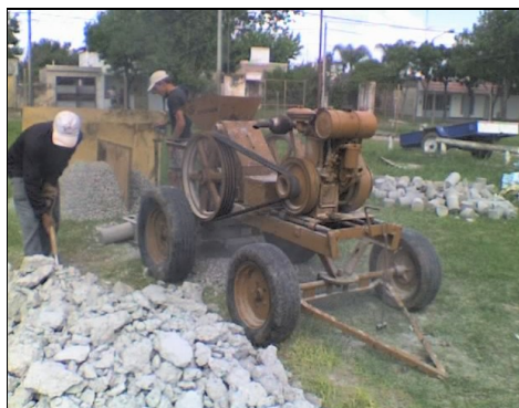
Figura 5. Equipo utilizado para la obtención de granza de hormigón.
