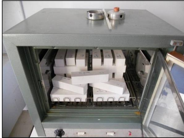
**Figura 7.10.** Secado de las probetas a  $45^{\circ} \pm 1^{\circ}\text{C}$ .
