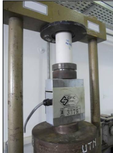
**Figura 7.31.** Cilindros. Ensayo de compresión simple.
