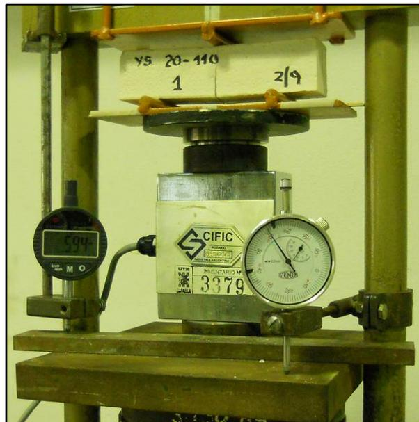
**Figura 7.25.** Prisma. Ensayo a la flexión.
