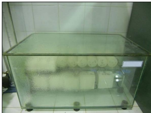
**Figura 7.9.** Curado de probetas en cámara húmeda.
