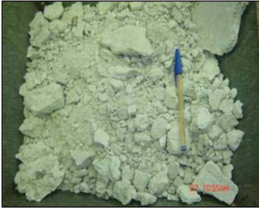
**Figura 7.6.** Yeso recuperado de pastas para revestimientos (YH), limpio y triturado.
