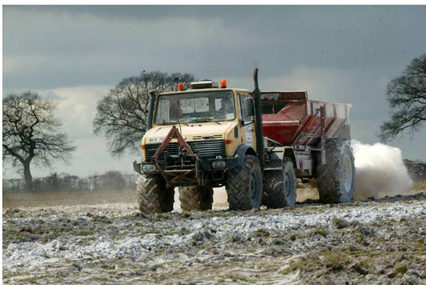
**Figura 6.1.** Distribución de yeso reciclado con un esparcidor de cal. (Fuente: Cartwright, 2007)
