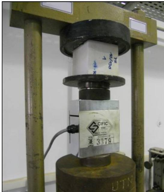
**Figura 7.22.** Cubos. Ensayo de resistencia a la compresión
