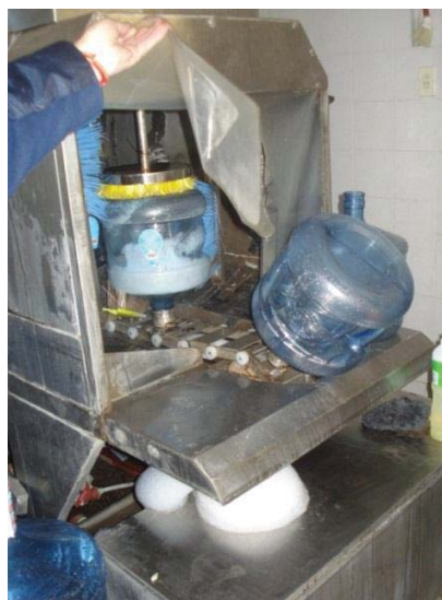
Figura N° 23 Detergente limpiador y proceso de lavado de envases (Fuente: Álbum propio; tomado de la planta Cimes Bahía Blanca)
