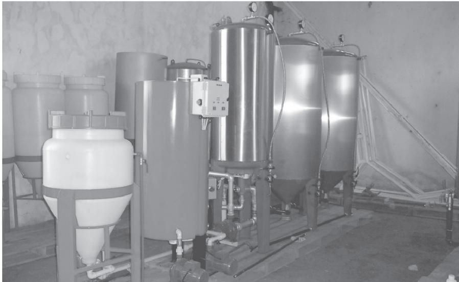
Equipamiento de Bioenergy para producir biodiesel. Nombrado desde el primero: 1. Equipo donde se prepara el metóxido (hidróxido de sodio y metanol). 2. Equipo para precalentar el aceite. 3. Reactor donde se produce la transesterificación. 4 y 5. Decantadores donde se separa el biodiesel del glicerol.
