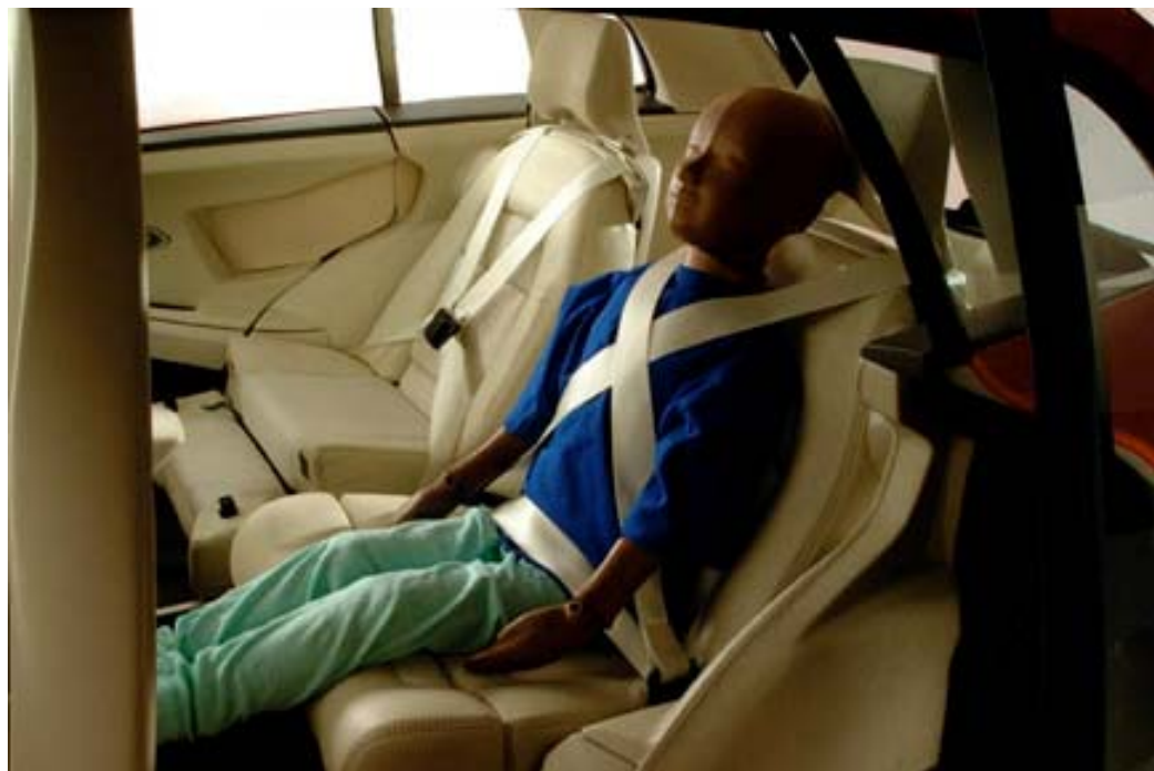
Aquí se observan por un lado la capacidad de los asientos de modificar la altura de acuerdo al tamaño del pasajero, y por el otro las dos alternativas de cinturón de seguridad de 4 puntos propuestas en el Volvo SCC.
