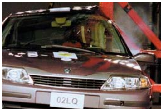
El airbag lateral no impide, lógicamente, la deformación del habitáculo ni el desplazamiento del conductor hacia la puerta.
