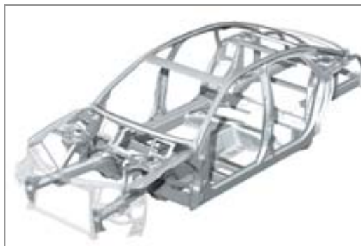
La estructura de aluminio del Audi A8, que representa la probable evolución de los automóviles en los próximos años.
