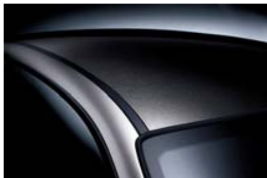
El techo de los automóviles de alta gama de la Serie 3 de BMW está hecho de fibra de carbono.
