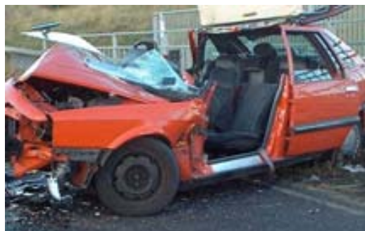
En este accidente se debió cortar los parantes delanteros y plegar el techo para auxiliar a los automovilistas atrapados.
