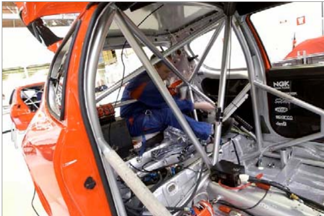
En esta foto de una de las fases de preparación de un Peugeot 206 WRC para carreras de Rally se observa claramente la multitud de refuerzos que se añaden a la estructura original para aumentar considerablemente su resistencia a los impactos.
