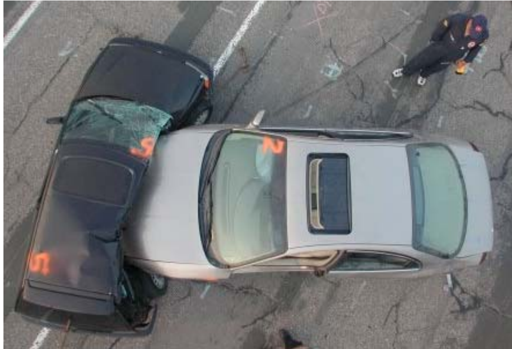
La fotografía es más que elocuente. En un impacto lateral, la estructura de un automóvil moderno permite que el habitáculo se deforme excesivamente, aplastando a los ocupantes del vehículo más cercanos al costado de la colisión.
