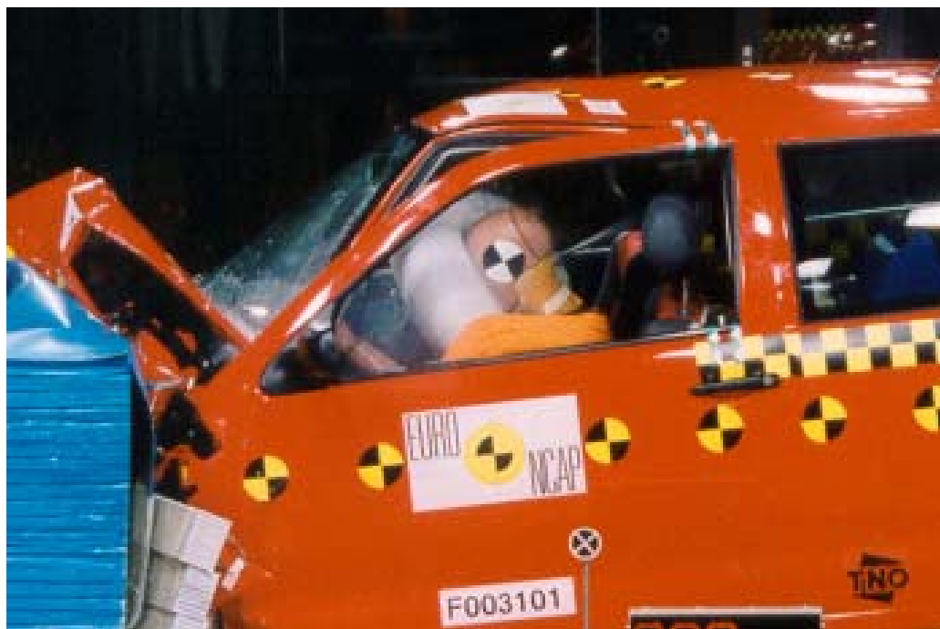
La proximidad entre el volante y la cabeza del conductor hace que muchas veces, según la velocidad original del impacto, la cabeza golpee un airbag que se está inflando todavía, y que puede provocar serias heridas a la víctima del accidente.
