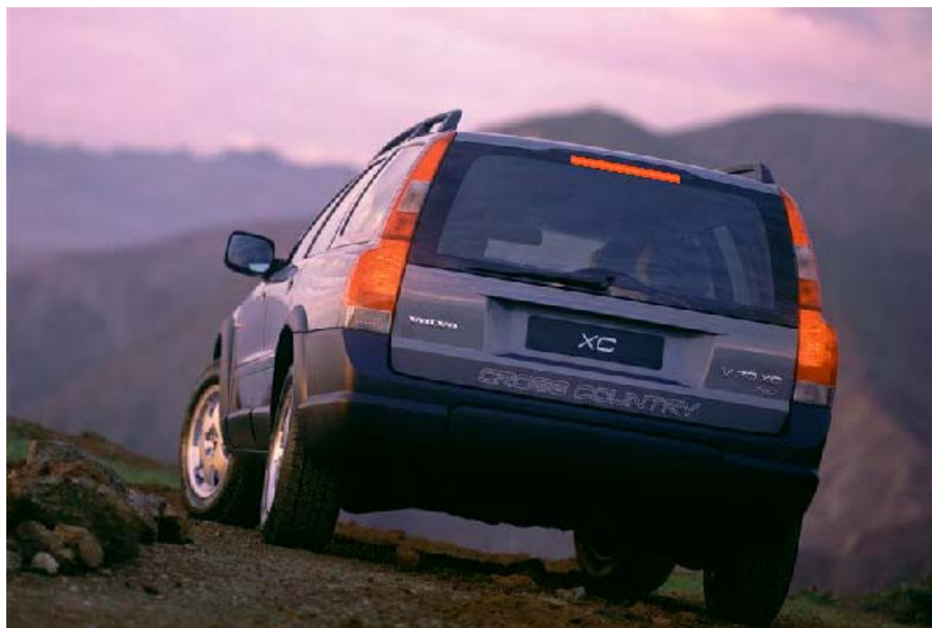
Muchos automóviles tienen el grupo de faros traseros verticales, y, todos, una tercera luz de freno en la luneta trasera.
