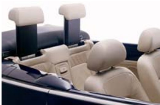
La mayoría de los automóviles convertibles tienen, por razones estéticas, dispositivos de activación automática ante vuelcos.
