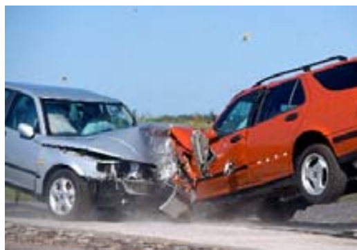
Imagen de una colisión entre dos automóviles realizada por Saab para ensayar choques más cercanos a la realidad.
