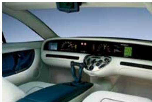
El interior del F200 prototipo de Mercedes-Benz que reemplaza el volante y los pedales por un joystick que concentra sus funciones.
