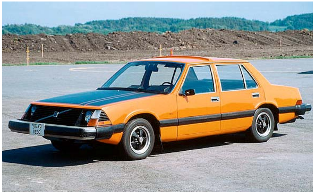
La imagen muestra el pronunciado paragolpes delantero del VESC. Además, esta misma característica se repetía en el paragolpes trasero, dando una señal acerca de la importancia de mantener la mayor distancia posible entre el habitáculo y el punto de impacto.
