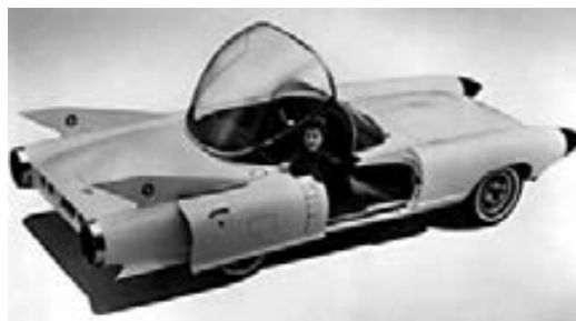
En 1959 la General Motors Company presentó el prototipo Cadillac Ciclone que, entre otros elementos futuristas, tenía en el frente dos dispositivos en forma de cono que medían la distancia al auto que circulaba adelante, indicando con una señal luminosa y otra sonora la proximidad de un vehículo.
