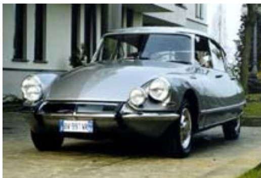
El Citroën DS tenía en 1955, entre otras características novedosas, un sistema de estabilización que actuaba sobre las suspensiones.
