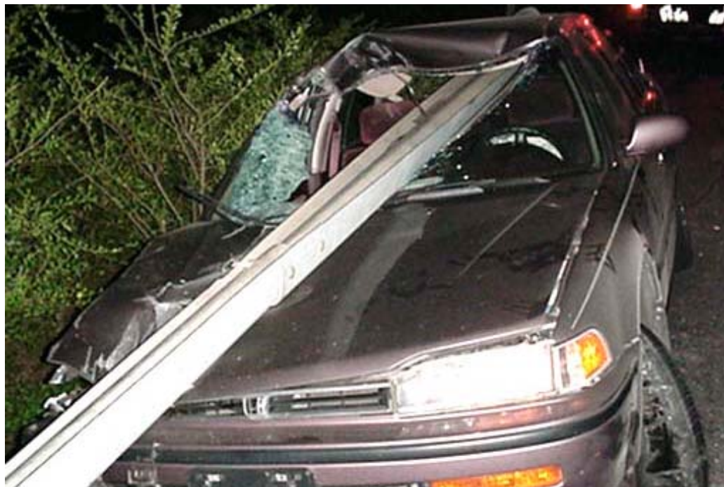
La relativa fragilidad del parabrisas permite que penetren en el habitáculo objetos potencialmente peligrosos.
