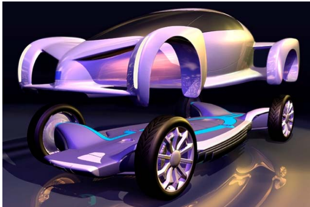
La original propuesta de la General Motors Company (en su "concept car" Hy-wire) que propone concentrar las estructuras de generación de potencia y transmisión de la misma en un conjunto compacto, denominado por su forma "skateboard".
