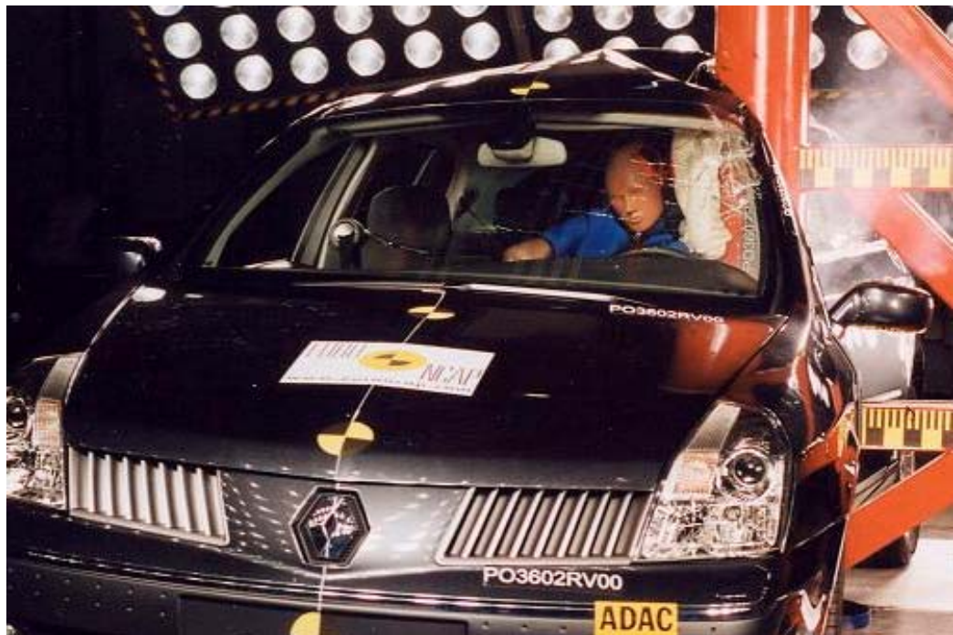
La estructura del Vel Satis no opone prácticamente ninguna resistencia al avance del poste dentro del habitáculo en este choque a 50 km/h, permitiendo que éste ocupe el espacio vital del conductor y que lo desplace hacia la derecha.
