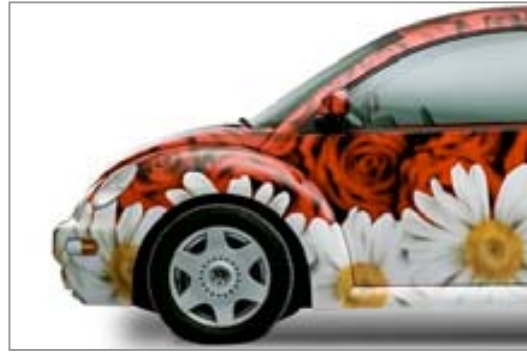
Una versión pintoresca del Volkswagen "New Beetle" que muestra la ausencia de salientes potencialmente peligrosas.
