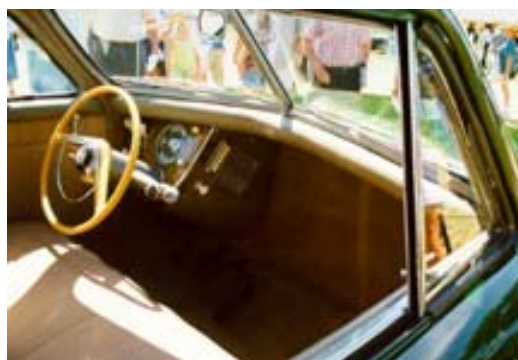
El Tucker de 1948 fue diseñado teniendo en cuenta la seguridad de impacto, e incluía la eliminación del peligroso tablero.
