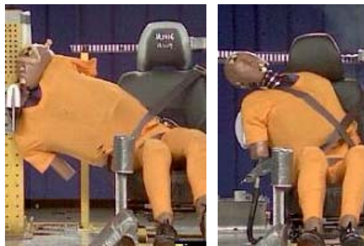
En la imagen de la izquierda se observa que el cinturón de tres puntos no es capaz de retener al ocupante en un accidente lateral. En cambio el cinturón de cinco puntos (derecha) sí lo logra.
