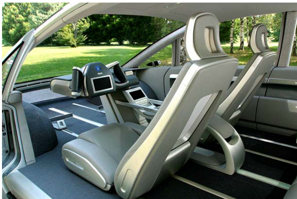
El habitáculo del prototipo Hy-wire de la General Motors Company muestra como uno de sus rasgos característicos la ausencia de tablero, o de conexión mecánica entre el volante y las ruedas, o el pedal de frenos y dichos dispositivos, entre otras novedades.
