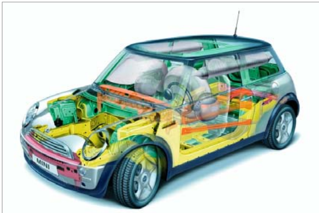
En este dibujo se pueden observar las estructuras encargadas de deformarse progresivamente ante el evento de un impacto delantero o trasero (en color amarillo).
