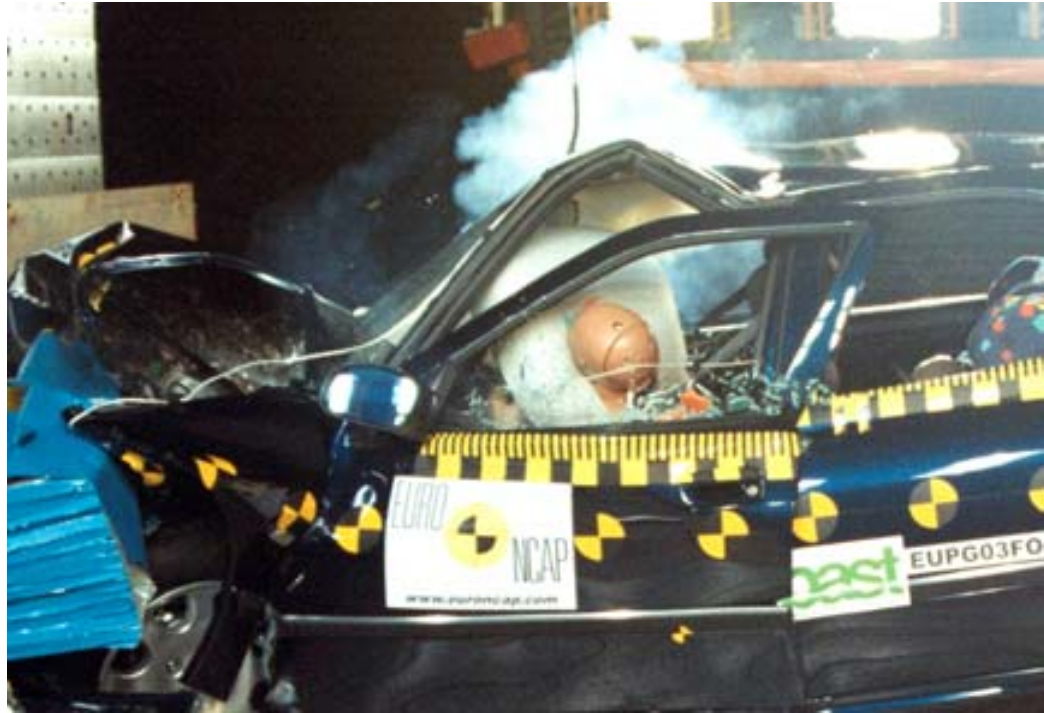
Esta fotografía del ensayo de un Peugeot 406 muestra una evidente deformación del habitáculo en un impacto frontal a una velocidad de 64 km/h. Sería de mucha utilidad poder observar qué ocurre con el habitáculo a velocidades de hasta 130 km/h.
