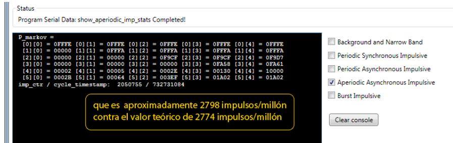
FIGURA 7.31: Captura de pantalla del software GUI. Contadores de estadísticas para el ruido impulsivo aperiódico asincrónico.
