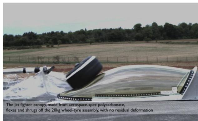
Figura 9 - Test de impacto de cabina de policarbonato
