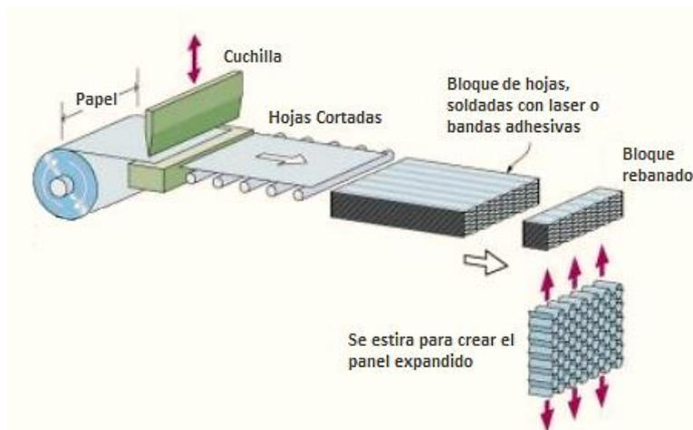
Figura 2: Proceso tradicional de fabricación de núcleo de panal de abeja.
