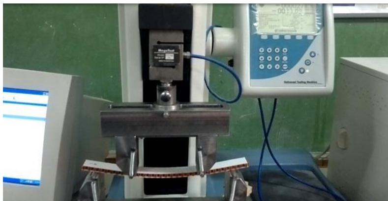
Figura 10: *Ensayo a la flexión con cuatro puntos.*
