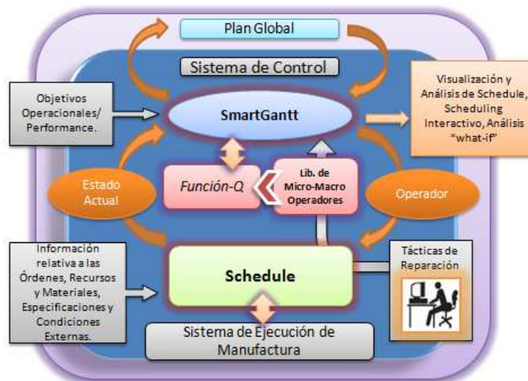
Figura 1. Arquitectura Basada en Reparación
