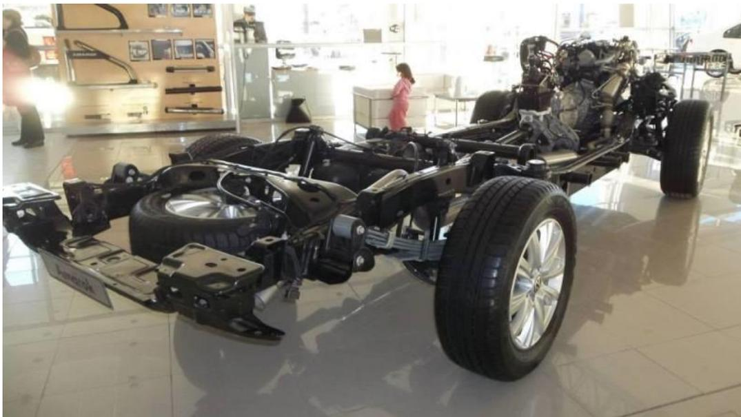
Figura 4A. Imágenes de los trenes delantero tipo doble A y trasero tipo eje rígido
