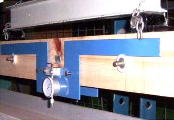
Fig. 8 - Fotografía de los dispositivos para la aplicación de cargas y medición de las deformaciones.
