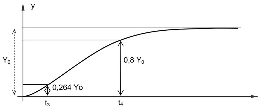
Fig. 3 Forma aproximada de la respuesta del sistema de segundo orden a la excitación de un salto escalón de amplitud  $Y_0$  cuando el valor de  $\zeta$  está comprendido entre 0,5 y 2.
