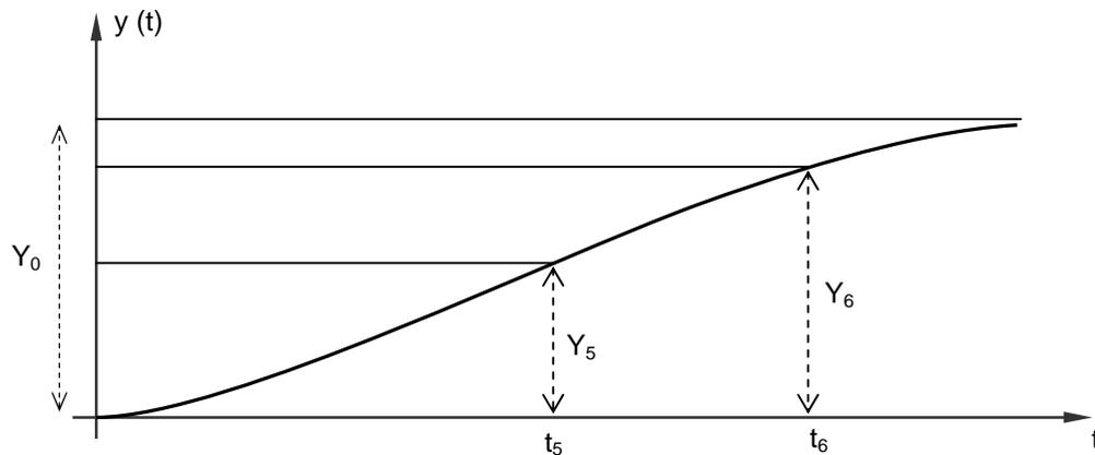
Fig. 4 Forma aproximada de la respuesta del sistema de segundo orden a la excitación de un salto escalón de amplitud  $Y_0$  cuando el valor de  $\zeta$  es mayor que 2.
